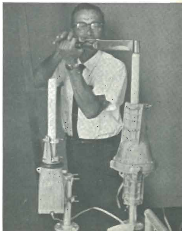
Fig. 6 - Verifica del momento torcente e momento frenante con la chiave dinamometrica.
