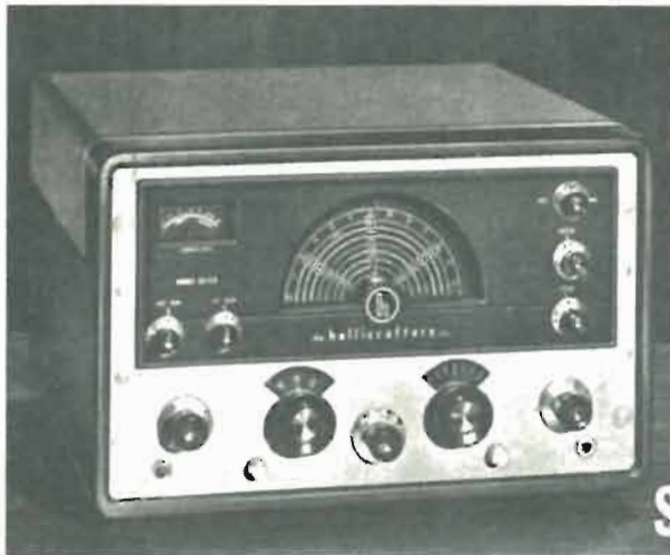
Fig. 2 - Lo SX 115 il ricevitore dell'anno 1960. Quattro circuiti accordati prima del mescolatore. Copre le cinque gamme amatori in porzioni di 500 kHz: quattro cristalli per la gamma 28 MHz, nel primo oscillatore di conversione.
